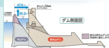
ダムのかさ上げによる治水機能の強化と水力発電の増強
