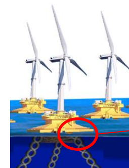
係留ラインからの反力を受ける箇所の例
