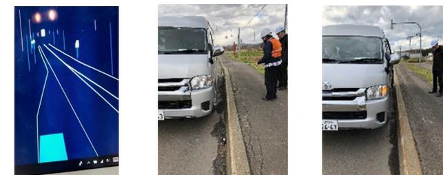
画面表示〔歩道端部〕から6~7cm程度離れた位置に操車し、停止位置の精度を確認
