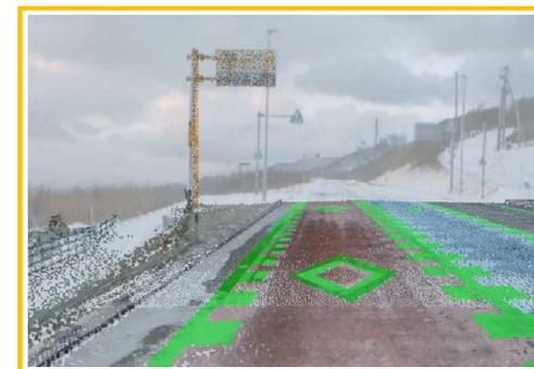
時速40km/hで走行し、AR画像の表示精度等を確認
