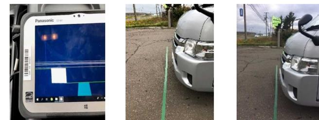
画面表示〔停止線〕に合わせて操車し、停止位置の精度を確認
