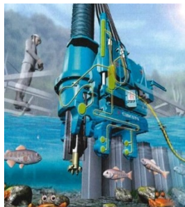
サイレントパイラー
