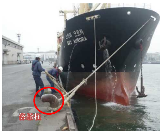
写真2：係船柱にロープをかける作業（名古屋港）
