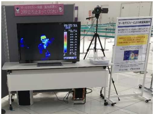
サーモグラフィーによる体温測定 (関西空港) 提供: 関西エアポート(株)
