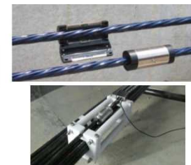
センサーによる橋梁ケーブル張力のモニタリング
