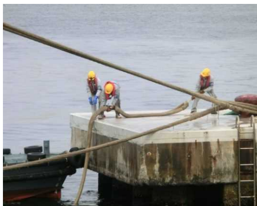
写真3：係船柱にロープをかける作業（神戸港）
