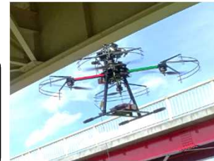
ドローンによる損傷把握
