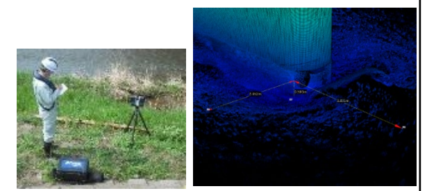
3次元座標データの取得による下部工の洗掘状況把握 <掲載技術名> スキャニングソナーとレーザースキャナによる橋梁基礎形状計測技術
