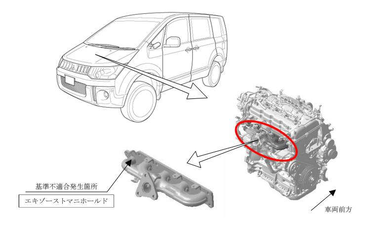
エキゾーストマニホールドにおいて、EGR(排気ガス再循環装置)用のパイプの構造が不適切なため、排気ガス処理システム作動時の熱負荷による、エキゾーストマニホールドの熱膨張・収縮の繰り返しにより、当該パイプの溶接部に亀裂が入ることがある。そのため、亀裂部より排気ガスが漏れるおそれがある。
