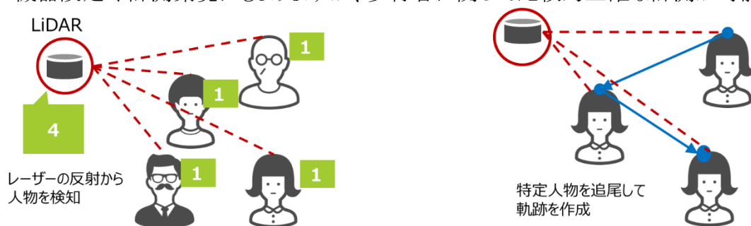
図 3 LiDAR によるカウントデータ(左)と軌跡データ(右)の取得イメージ
