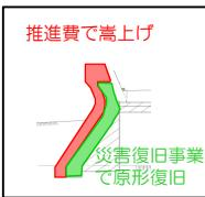
対策例：被災した護岸を災害復旧事業による原形復旧にあわせて、推進費により嵩上げを実施。
