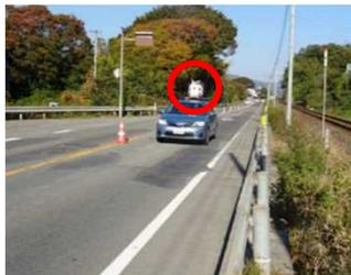
車載装置による路面性状測定
