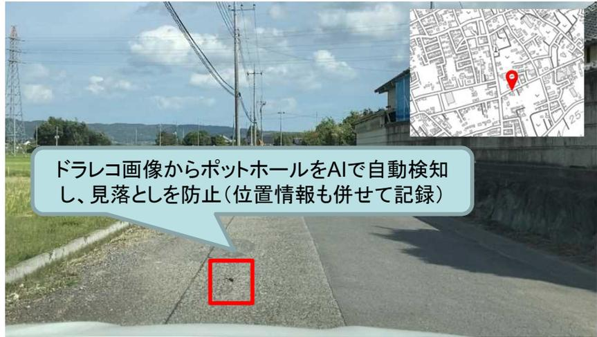
ドラレコ画像からポットホールをAIで自動検知し、見落としを防止(位置情報も併せて記録)
