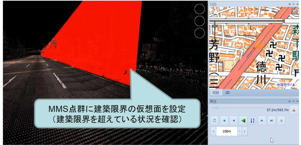
MMS点群に建築限界の仮想面を設定(建築限界を超えている状況を確認)
