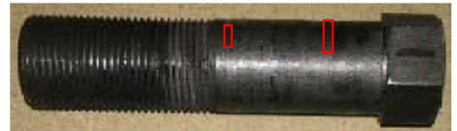
写真4 エアギャップ調整ボルトの圧痕(写真1左下の○部分)
