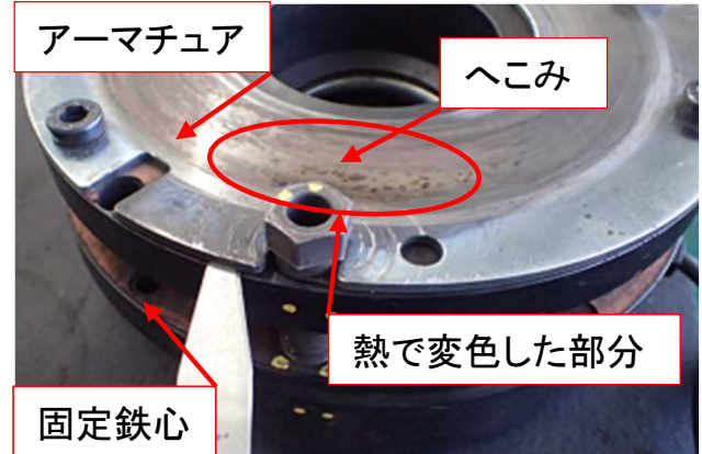
写真2 アーマチュアのへこみ及び変色部(パッド接触部)
