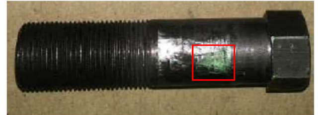
写真3 エアギャップ調整ボルトの擦過痕(写真1右下の○部分)
