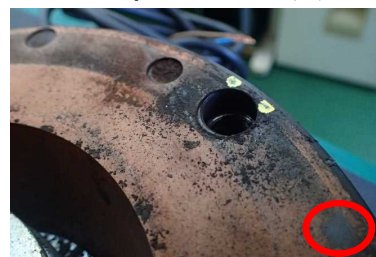
写真5 固定鉄心の付着物
