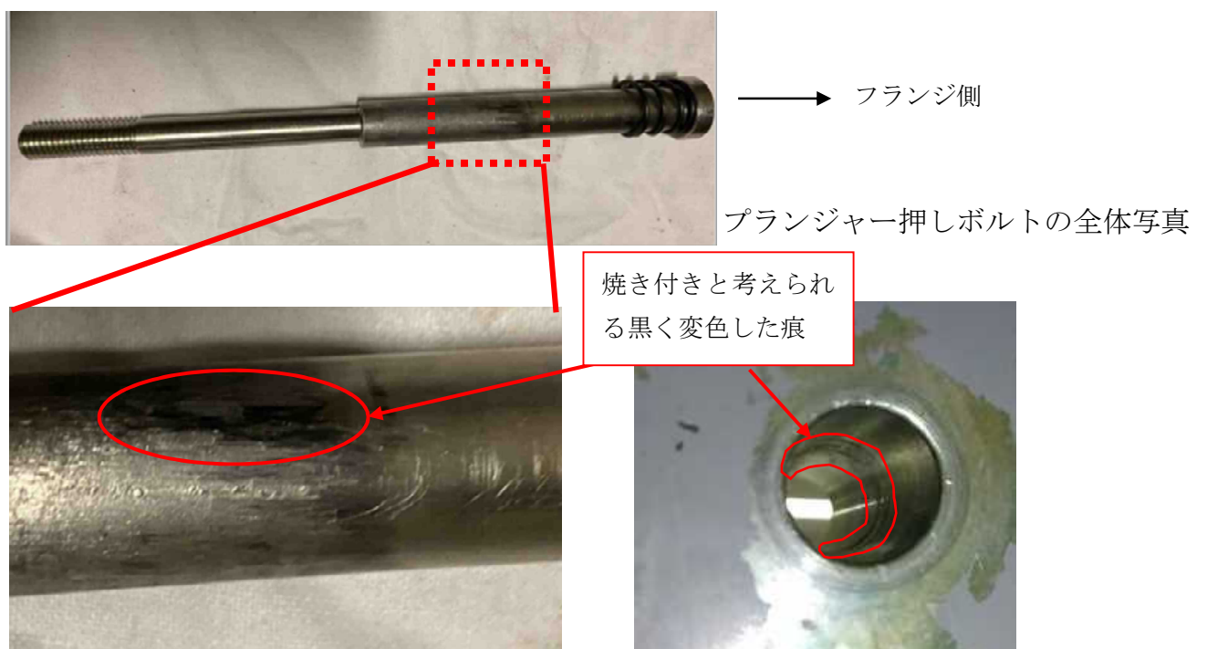
写真5 プランジャー押しボルト
