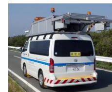
3次元レーザーセンサー を用いた舗装損傷検知
