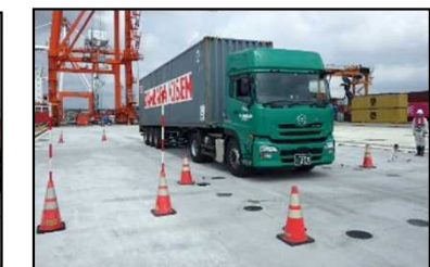
動的載荷試験実施状況
