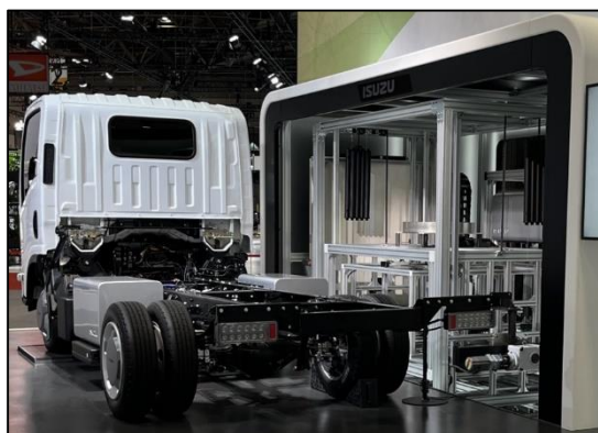
バッテリー交換式 EV（トラック）の例（日本自動車工業会提供）
