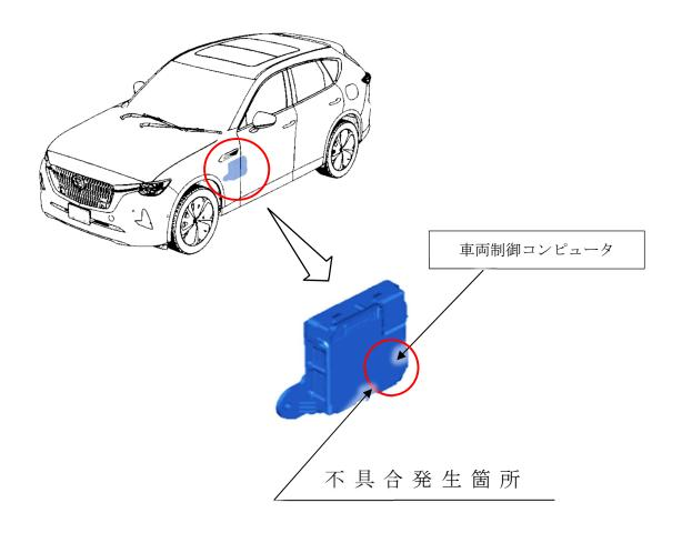
車両制御コンピュータにおいて、スマート・ブレーキ・サポートの制御プログラムが不適切なため、道路横に斜めの金属壁などがあった場合に、前進時左右接近物検知機能が誤作動することがある。そのため、衝突の可能性がないにもかかわらず障害物との接近を知らせる警報音が鳴り、ディスプレイに警告表示が出て、最悪の場合、衝突被害軽減ブレーキが作動し、急制動がかかるおそれがある。
