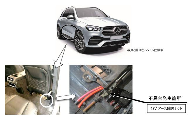
注: は、締め付けトルクを点検する部位を示す。
