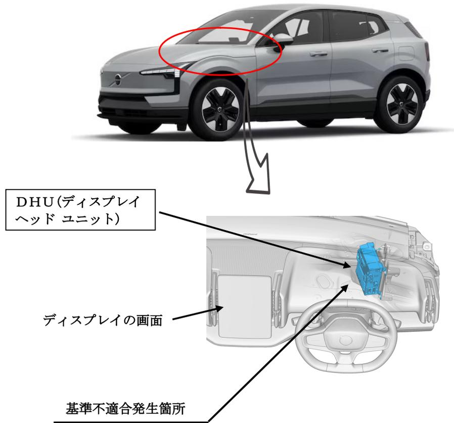
DHU (ディスプレイヘッドユニット) において、制御プログラムが不適切なため、EVシステム始動時に、ディスプレイの画面がテストパターン(カラーバー)になることがある。そのため、後退時車両直後確認画像、速度計及び警告灯等が表示されないおそれがある。
