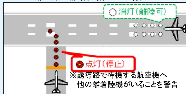
航空機接近警告灯(REL)
