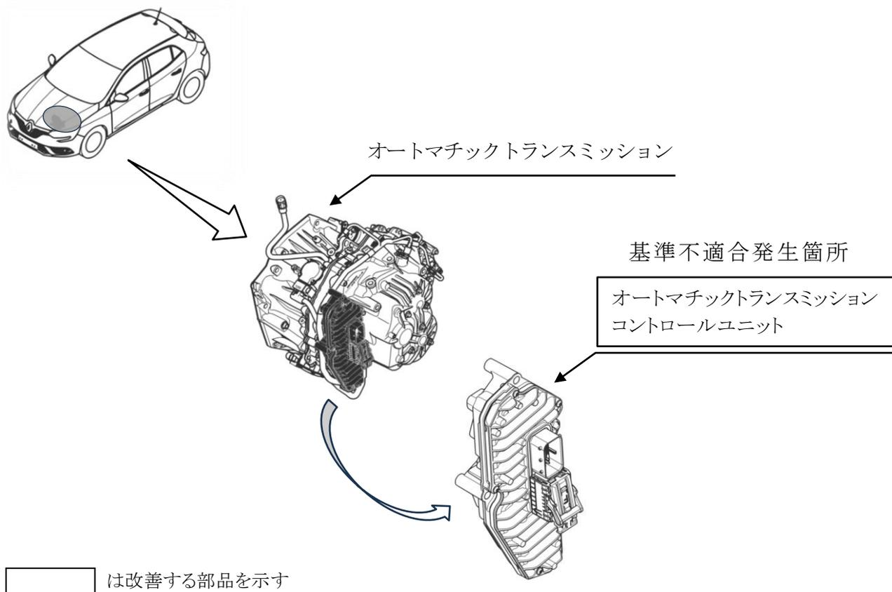
オートマチックトランスミッション・コントロールユニット(ATCU)において、誤った制御プログラムが書き込まれたため、ストップ&ゴー機能付きのアダプティブクルーズコントロールが作動中、先行車に接近した際に一定速度まで減速した後の停止制御が正常に作動しない。そのため、減速制御が作動した後にクリープ現象が続き、先行車に追突するおそれがある。
