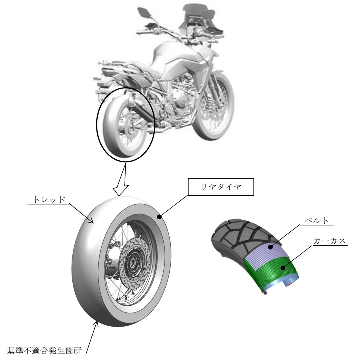
リヤタイヤにおいて、製造時のバラツキで、内部のベルトとカーカス間のゴムが薄くなるものがある。そのため、内部のベルトとカーカスが剥離し、トレッド部に亀裂や変形が生じることで異常振動が発生し、そのまま使用を続けると最悪の場合、トレッド部が剥離して走行安定性を損なうおそれがある。
