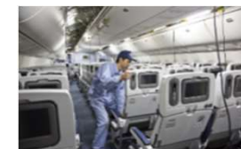
客室内椅子の取付・取外し
