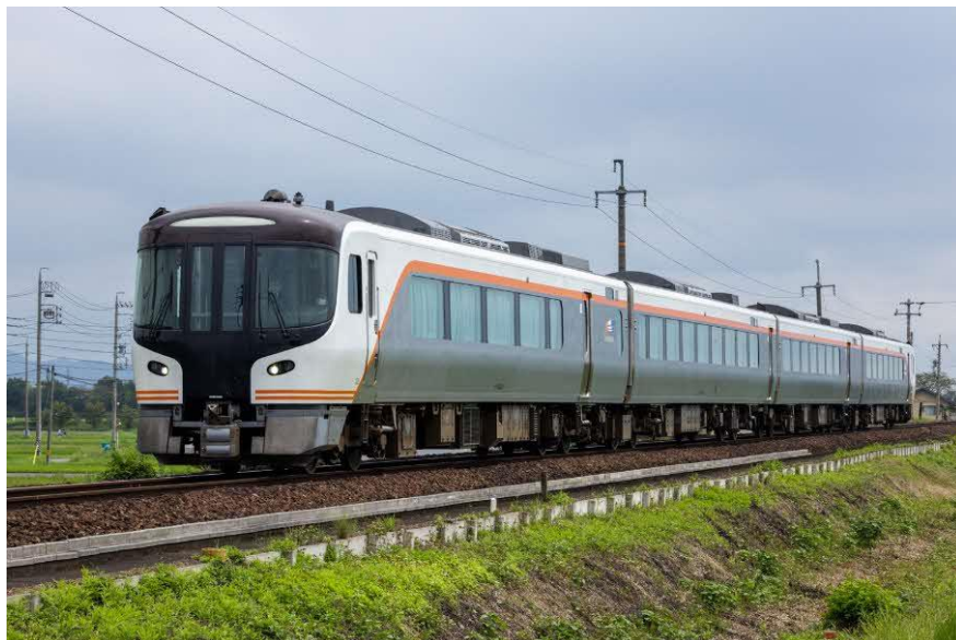
従来の車両よりCO2排出量を約30%低減したHC85系車両
