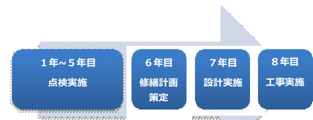
(2) 点検～工事サイクル (過去の事例)
