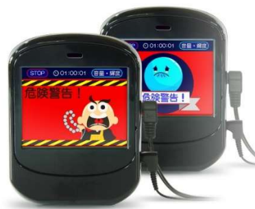
図 4-12 【危険警告】判定をドライバーに伝える開発装置
