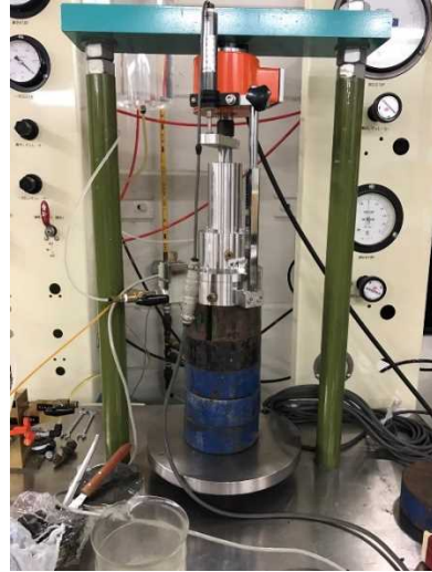
写真-3.1 定ひずみ速度圧密試験機
