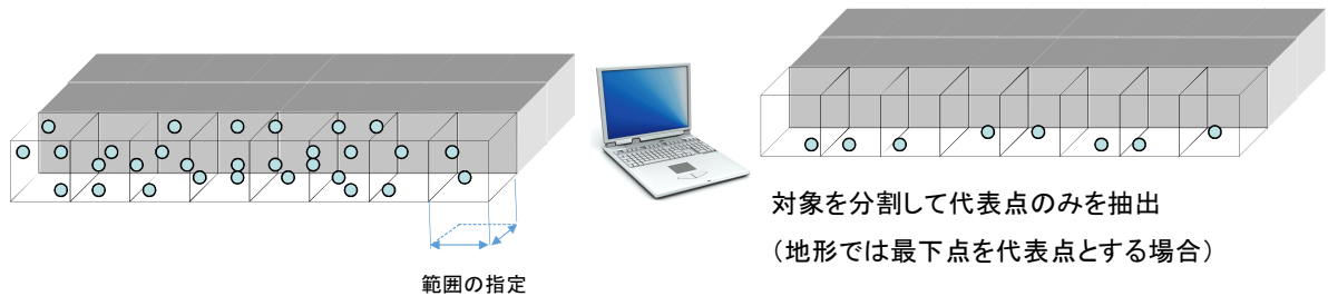
図 3-5 点群データの密度を均一にする方法（例）
