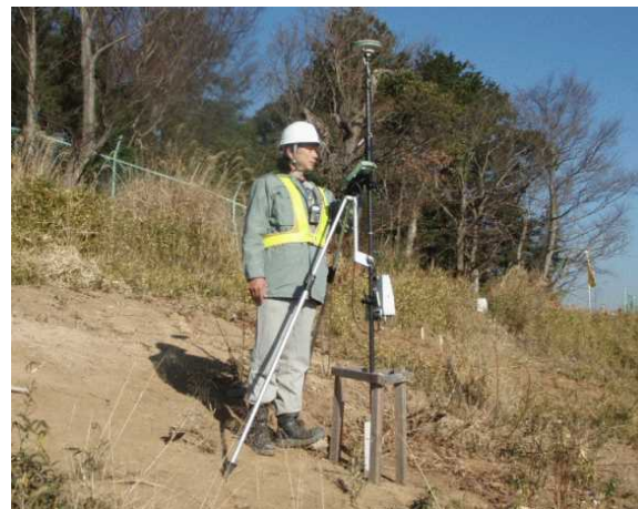
写真 - 6 ローカライゼーション測量状況
