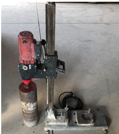
コンクリート穿孔機全景
