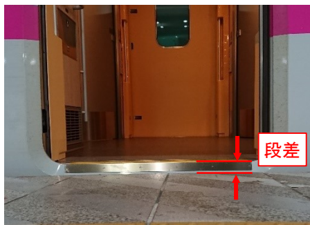
車椅子対応号車である5号車・9号車の乗降口幅は1,010mm。その他は660mm
