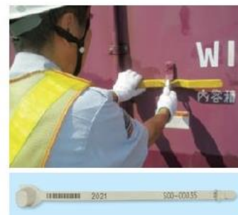
シリアルナンバー印字の封印環で輸送中のセキュリティ確保
