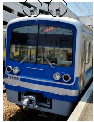
車上無線機アンテナ
